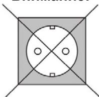
*Розетки - не предназначены для измерения (тестирования) сопротивления изоляции!*
