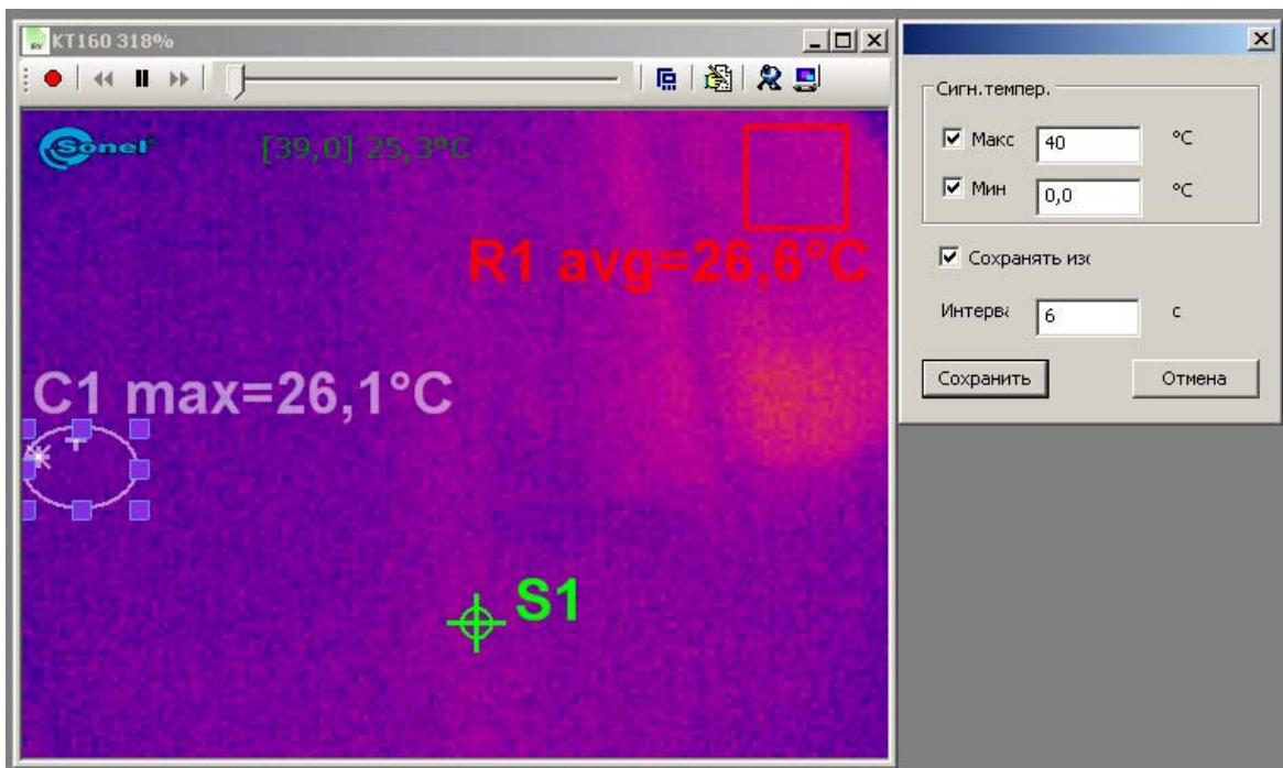
Если пользователь установит «Сохранять изображение» в момент выхода за пределы установленного температурного диапазона, будет сохраняться изображение экрана. Запись будет продолжать все время, пока температура будет за установленными пределами с заданным интервалом времени в секундах.
