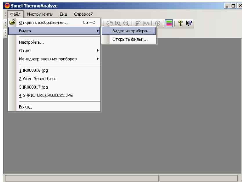
Тепловизор должен быть подключен через USB кабель. Рекомендуется подключать тепловизор после включения питания и успешного прохождения автотестирования. Программу Sonel ThermoAnalyze запускать после подключения тепловизора.
