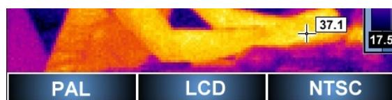
После выбора PAL, LCD или NTSC необходимо подтверждение (клавиша ДА). Обращаем внимание, что после выбора типа видеосигнала, дисплей тепловизора погаснет, а отображение будет производиться только на внешнем дисплее.
