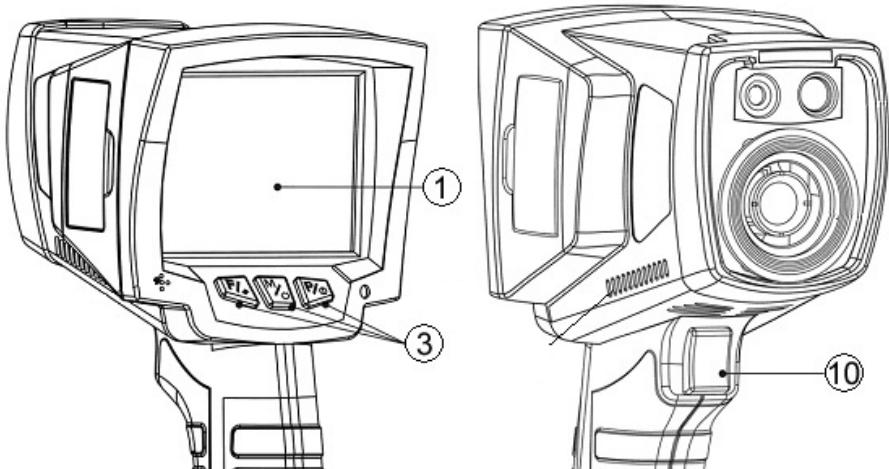
Для выбора функционала тепловизора используются клавиши управления (3), расположенные под LCD-дисплеем, а также курок (10).
