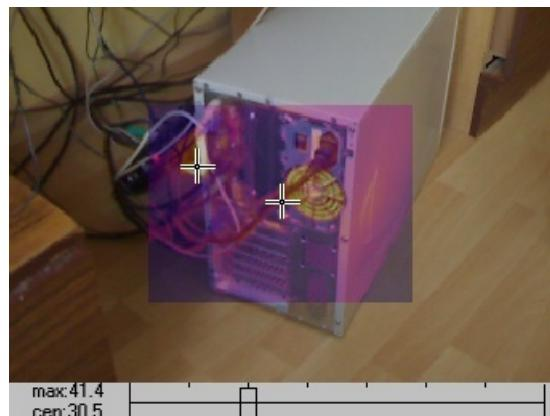
Клавишами и возможно установить уровень прозрачности тепловизионного изображения. Значение установленного уровня отображается на шкале в нижней части дисплея.
