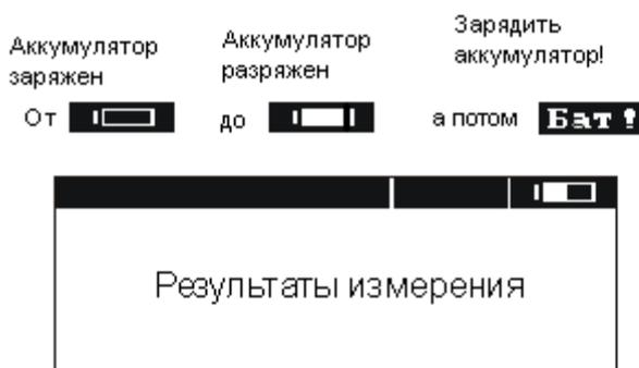
Рис. 13. Контроль состояния зарядки аккумуляторов
