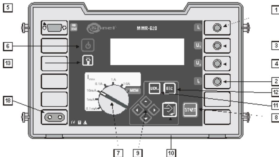
Рис.1. Расположение гнёзд и клавиш в измерителе MMR-620/610 (передняя панель)
