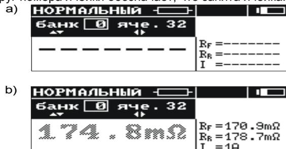
Рис.10. Вид экрана во время записывания в память:
