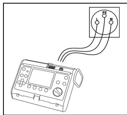
Рис.4. Подключение измерителя.
