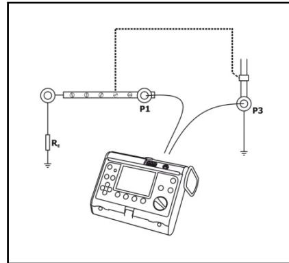
Рис 17. Подключение измерителя.
