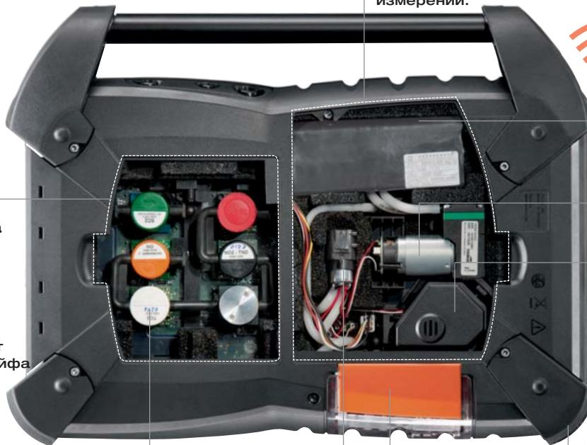
Предварительно откалиброванные **сенсоры газа** можно заменить, переставить местами или дополнить соответствующими параметрами измерения без использования поверочного газа – при необходимости это можно выполнить непосредственно на объекте измерений.
