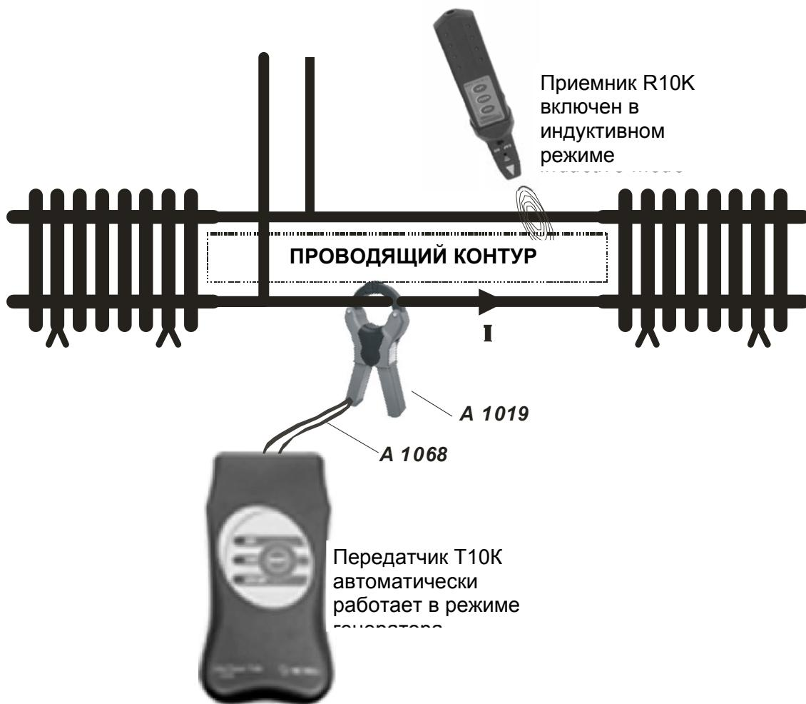
*Рис. 18 Трассировка проводящих контуров с помощью токовых клещей*
