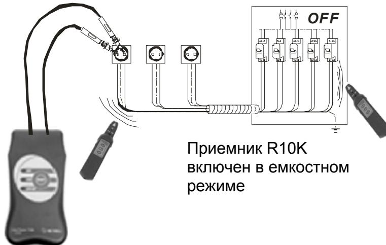
Передатчик T10K автоматически работает в режиме генератора
