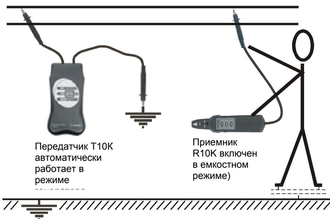
**Рис. 9 Поиск электрического поля линии*****Возможности обнаружения траассируемого объекта***
