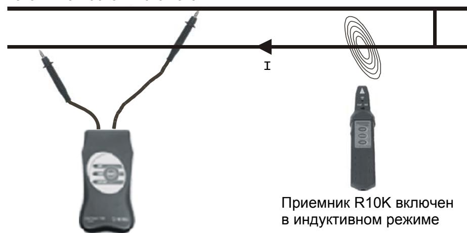
Передатчик T10K автоматически работает в режиме генератора
