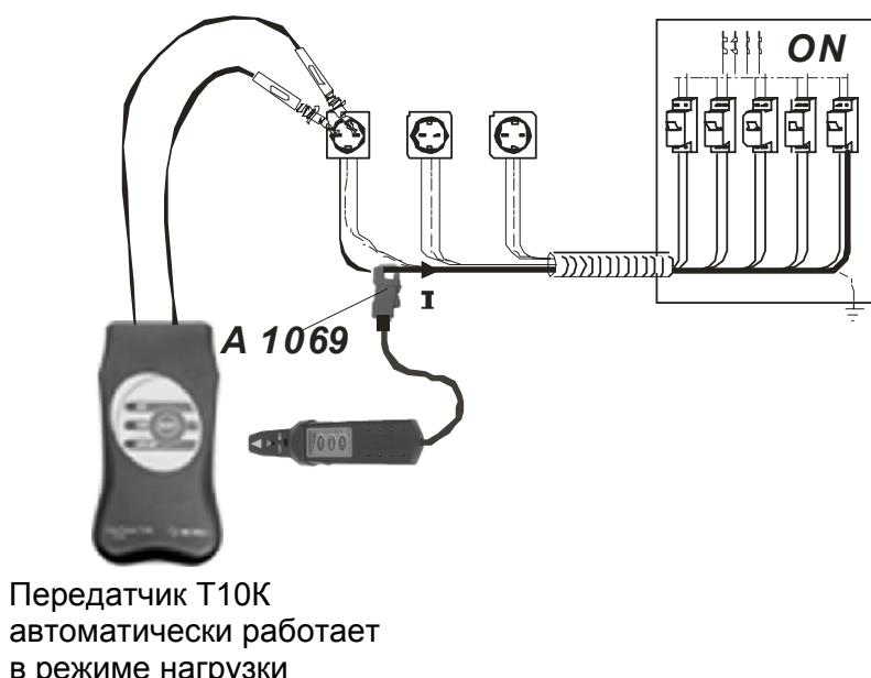
*Рис. 17 Поиск предохранителя с использованием токовых клещей.*
