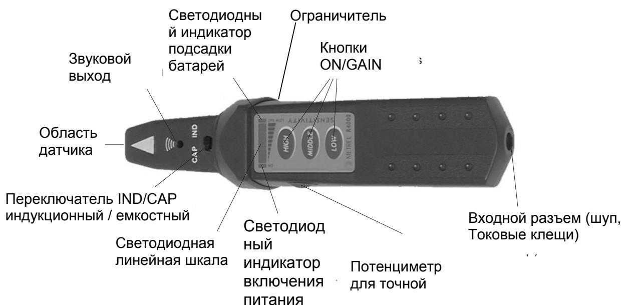
*Рис. 2 Приемное устройство R10K*
