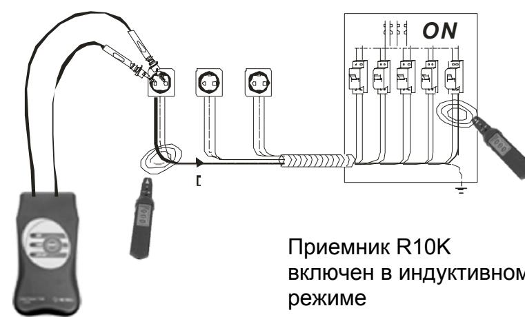
Передатчик T10K автоматически работает в режиме нагрузки
