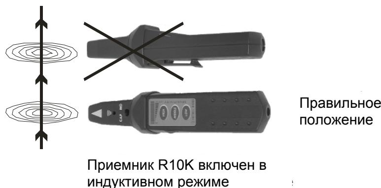
*Рис. 4 Обнаружение электромагнитного поля*
