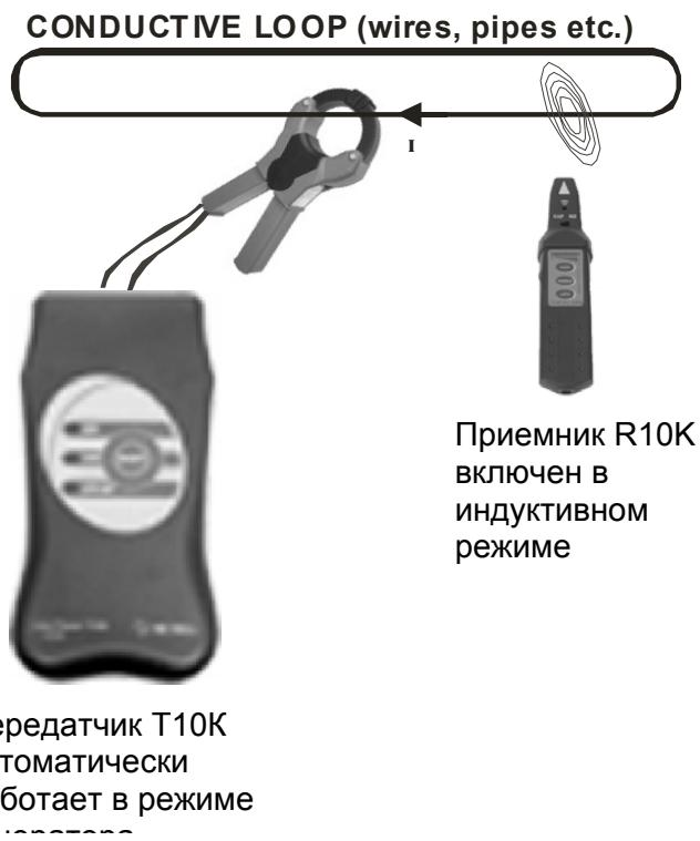
**Рис.8 Подача испытательного тока на замкнутый трассируемый контур с помощью токовых клещей**
