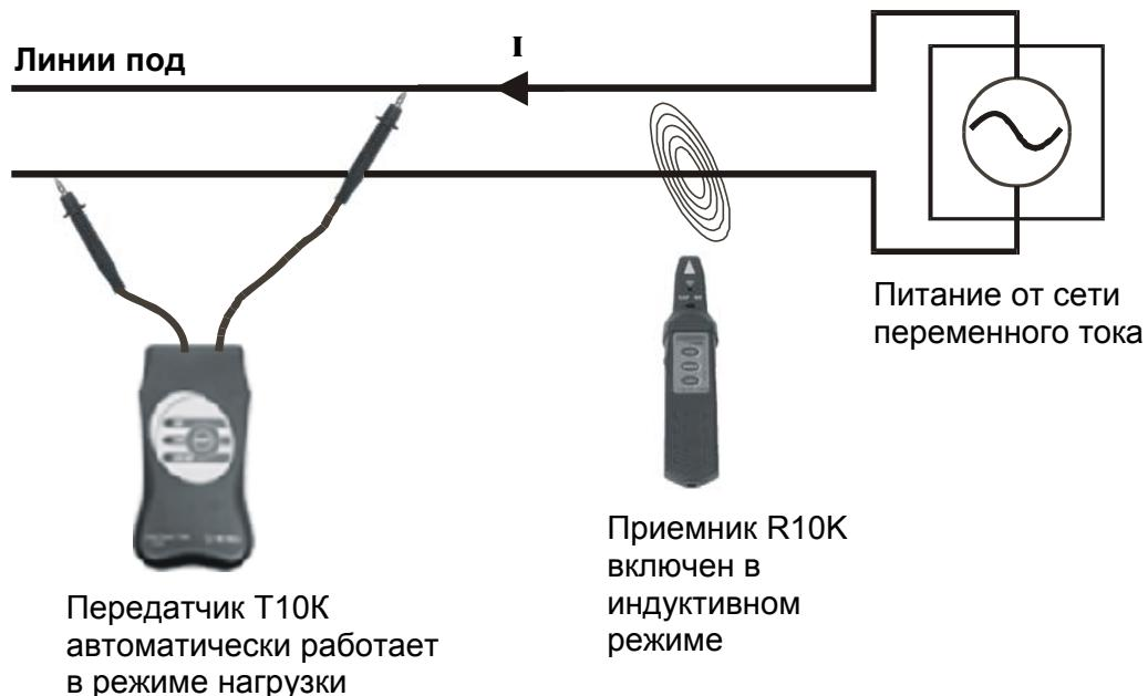
Рис. 3 Передатчик работает как активная нагрузка
