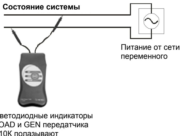
*Рис. 11 Передатчик работает в качестве детектора состояния системы*
