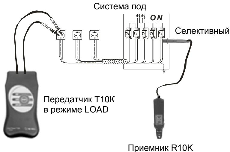
*Рис.6 Поиск предохранителя*
