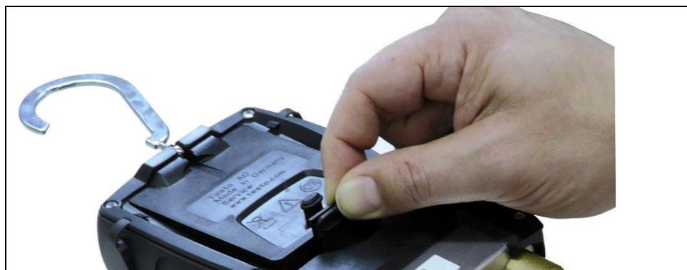
1. Откиньте кронштейн для подвешивание, ослабьте фиксатор и снимите крышку аккумуляторного отсека.
