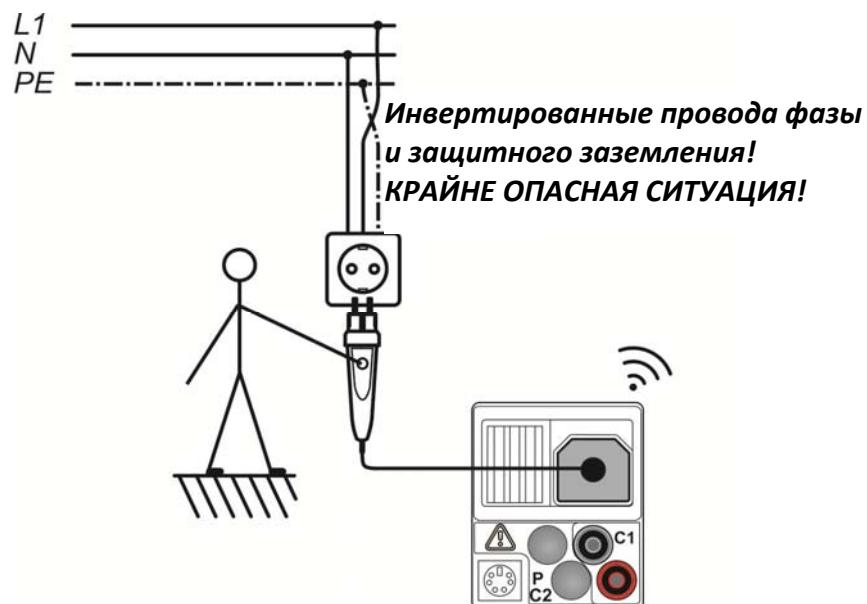
Рисунок С.4: Инвертированные проводники  $L$  и  $PE$
