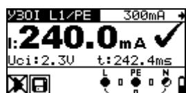
Рисунок 5.23: Пример результата измерения тока отключения
