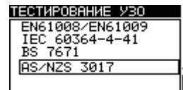
Рисунок 4.8: Выбор стандарта тестирования (испытаний) УЗО
