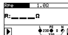
Рисунок 5.53: Сопротивление провода защитного заземления PE
