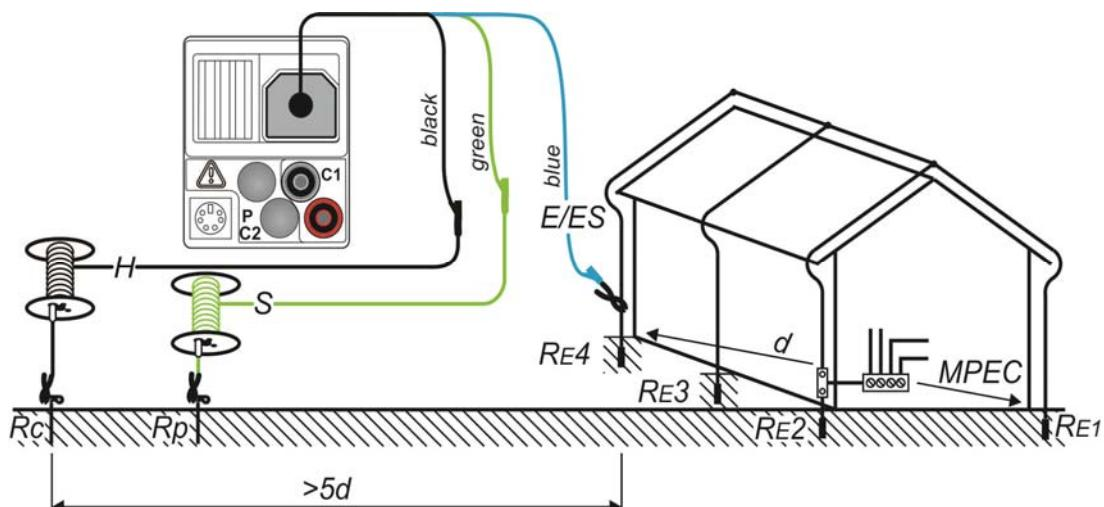
Рисунок 5.37: Сопротивление заземления, измерение сопротивления системы молниезащиты
