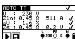
Рисунок 6.6: Пример с результатами автоматической последовательности AUTO TT
