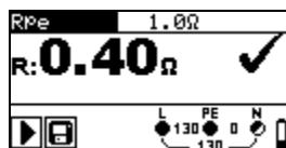
Рисунок 5.55: Пример результатов измерения сопротивления провода защитного заземления
