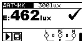
Рисунок 5.58: Пример результата измерения освещенности
