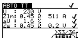
Рисунок 6.7: Пример с вызываемыми результатами автоматической последовательности AUTO TT
