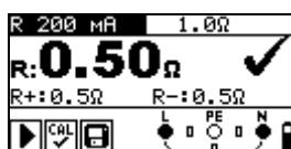
Рисунок 5.13: Пример результатов измерения R200 mA
