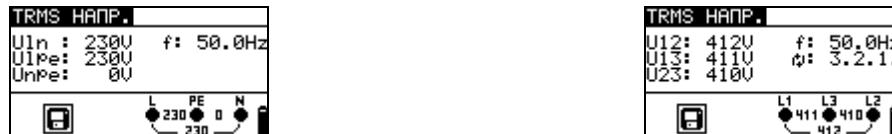
Рисунок 5.4: Примеры измерения напряжения в трехфазной цепи
