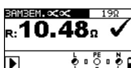
Рисунок 5.40: Пример результатов бесконтактного измерения сопротивления заземления
