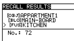
Рисунок 7.12: Пример меню с настраиваемыми названиями элементов структуры установки
