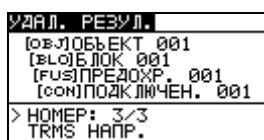
Рисунок 7.9: Меню для удаления отдельных измерений (выбрана область структуры установки)
