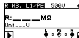
Рисунок 5.5: Сопротивление изоляции
