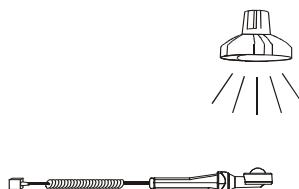
Рисунок 5.57: Позиционирование щупа люксметра
