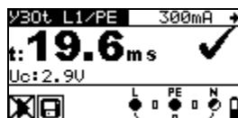
Рисунок 5.22: Пример результатов измерения времени отключения
