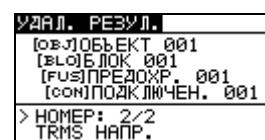
Рисунок 7.11: Дисплей после удаления измерений
