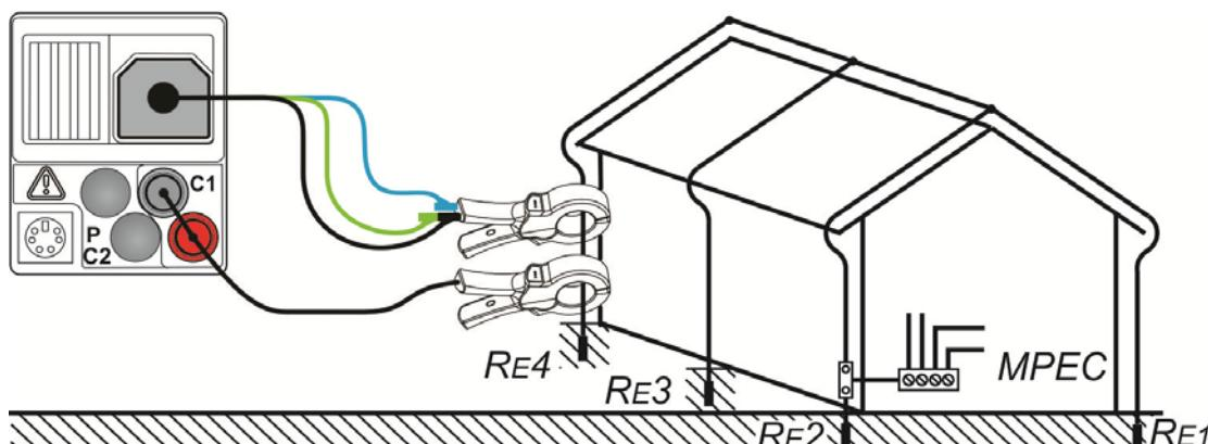
Рисунок 5.39: Бесконтактное измерение сопротивления заземления
