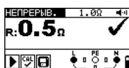
Рисунок 5.15: Пример непрерывного измерения сопротивления
