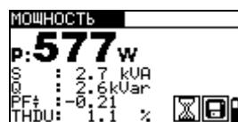
Рисунок 5.47: Результаты измерения мощности
