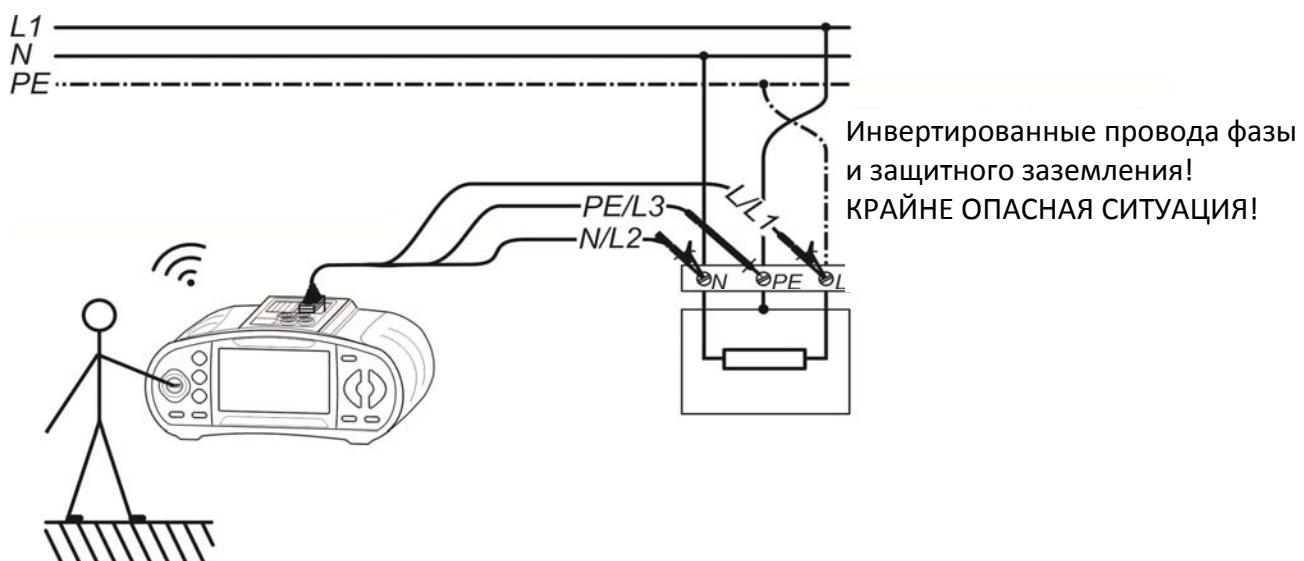
Рисунок 5.44: Инвертированные провода фазы и защитного заземления (L и PE) (применение 3-х проводного тестового кабеля)
