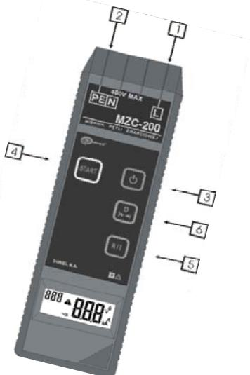
Рис.1. Расположение гнёзд и клавиш в измерителях семейства MZC-200 (лицевая панель)
