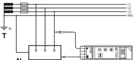
Рис. 8а. Тестирование эффективности защиты корпуса электроустановки сети T-N
