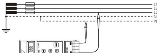
Рис.6. Измерение в защитной цепи (L-PE)
