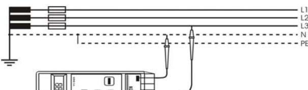
Рис.5. Измерение в рабочей цепи (L-N)
