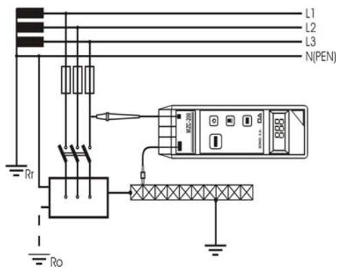
Рис. 11. Контроль целостности нулевых защитных проводников и уравнительных соединений.
