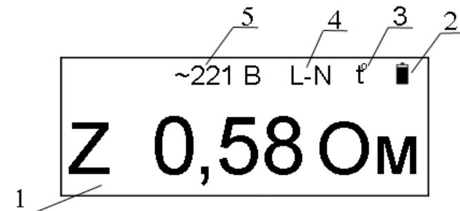
Рисунок 1.4.4 – Вид индикатора в режиме «фаза-нуль». Режим дисплея – сокращенный.
