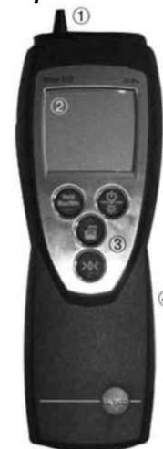
⌘ IR(инфракрасный) интерфейс, штуцеры (Ø4/6мм):
