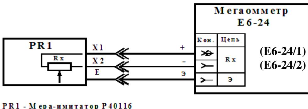
Рисунок 6. 7.2 - Схема проверки измерения сопротивления
