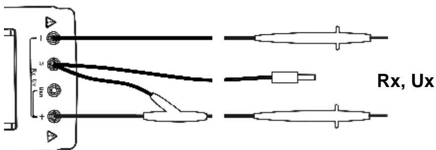
Рисунок 2.1.3в - Подключение кабелей к мегаомметру Е6-24/2
