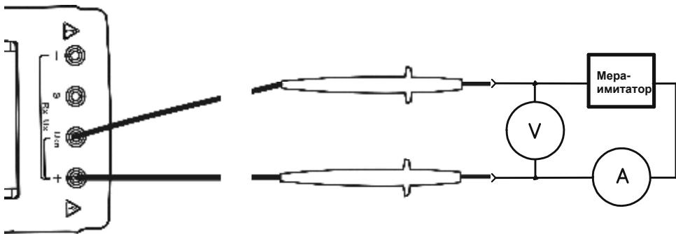
Рисунок 6.7.5 Схема подключения Е6-24/2 для проверки режима
