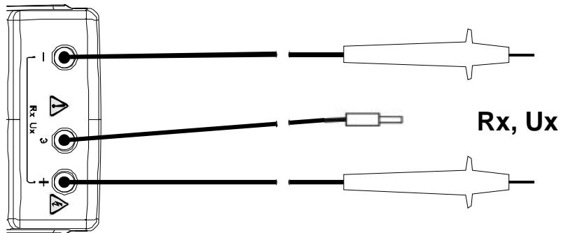
Рисунок 2.1.3а - Подключение кабелей к
