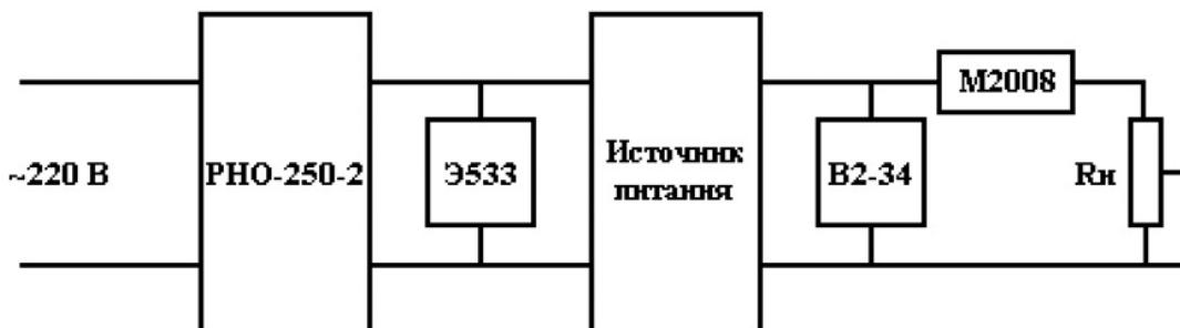
**Рисунок 1.** Структурная схема измерения нестабильности выходного напряжения при изменении напряжения питающей сети в режиме стабилизации напряжения.
