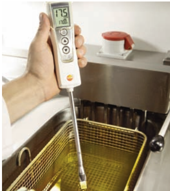
Рис. 12: Измерение значения TPM масла для жарки с помощью testo 270
