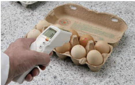
Рис. 5: Инфракрасное измерение поверхностной температуры пищевых продуктов
